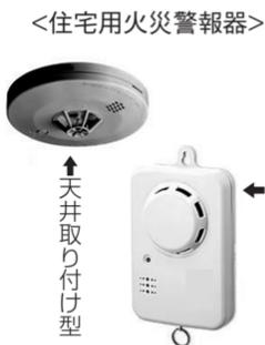
住宅用火災警報器の取り付け場所は、寝室・階段・台所です。煙を感知する「煙式」と熱(温度)を感知する「熱式」があります。寝室と階段には「煙式」を、調理などで煙が出やすい台所には「熱式」を設置してください。天井または壁の上部に取り付けます。
