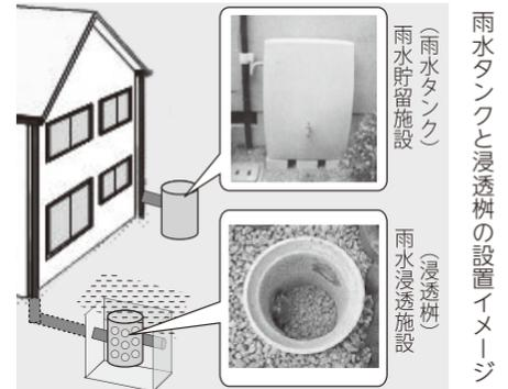
市は、雨水タンクと浸透枳(ます)の設置へ助成制度を実施しています。雨水タンクは屋根に降った雨をためる施設で、浸透枳は流れ込んできた雨水を地中に浸透させる施設です。側溝や下水道管に流れ込む雨水を少しでも減らして浸水被害を軽減し、雨水を土に返して健全な水循環を構築します。
