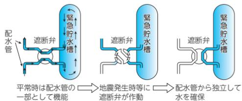
平常時は配水管の一部として機能 → 地震発生時等に遮断弁が作動 → 配水管から独立して水を確保
